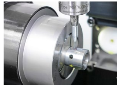
Analoger Scan eines konischen Langlochs
