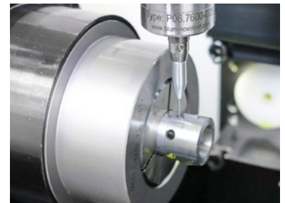
Escanéo analógico de un agujero cónico alargado
