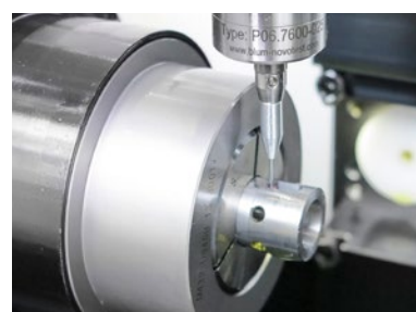
Skanowanie analogowe wydłużonego otworu stożkowego
