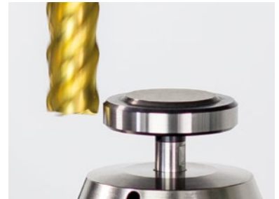
Medición de radio de herramienta
