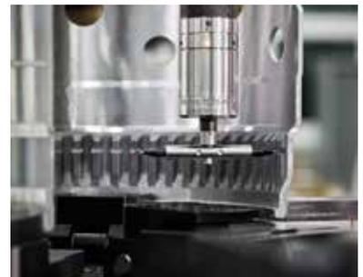
Präzise Messungen mit dem kompakten BLUM Messtaster mit verschleißfreiem Messwerk
