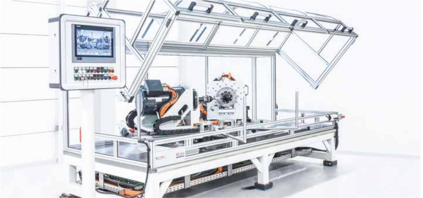
高级异响分析测试台用于测量传动轴异响情况及其功能性分析。传动轴可由程序加载控制扭矩或可在两端节处手动摆角互相独立加载。
