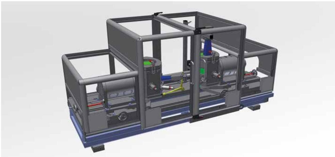
该台架用于测试高速传动轴护套在变化的转速、摆角角度及温度下（常温至200 °C）的特征性能
