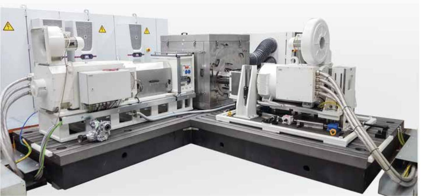
该试验台用于角向布局变速箱单元的测试，可通过自动或手动模式执行各种测试程序，例如：使用寿命试验、高转速试验等。试验台各组件成90°布局安装于床身上。可监测试验件的下述测量变量：扭矩、转速、弯曲度、试验件内部油温。
