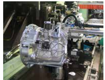
Getriebe vor Aufspannplatz in Wartestellung
