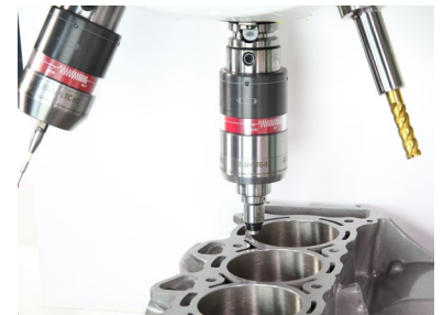
TG82 – wird wie ein Messtaster in die Werkzeugspindel eingewechselt
