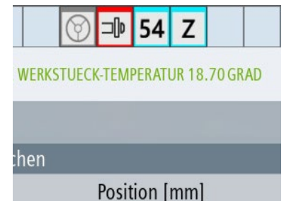
TG82: Die Temperatur wird direkt auf dem Steuerungsbild ausgelesen
